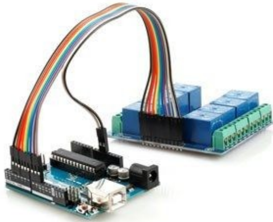
Relämodul ansluten till Arduino Uno.
